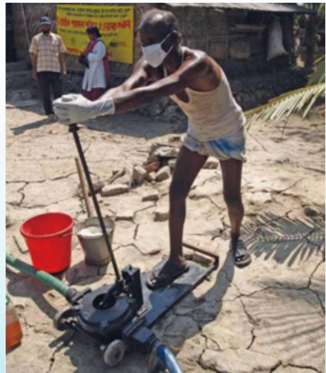
Kielelezo 4-3: Pampu ya Dayaframu ya kuvutia topekinyesi (Chanzo: Stranda, 2014 uk. 76)
